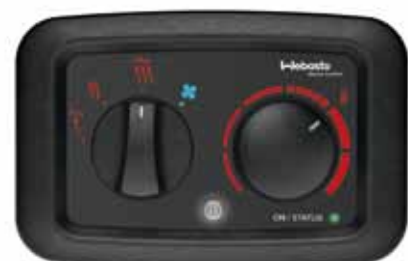
Urządzenie sterujące Air Top Evo – możliwość wyboru trybu pracy
